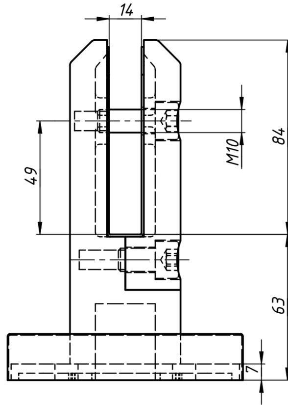
Отверстие в стекле - Ø 12 мм
